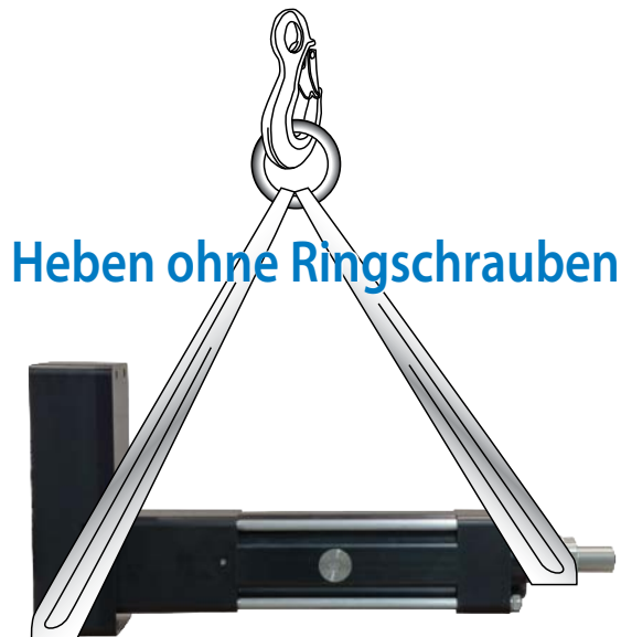
Abbildung 4-2 RSX richtig heben ohne Ringschrauben
